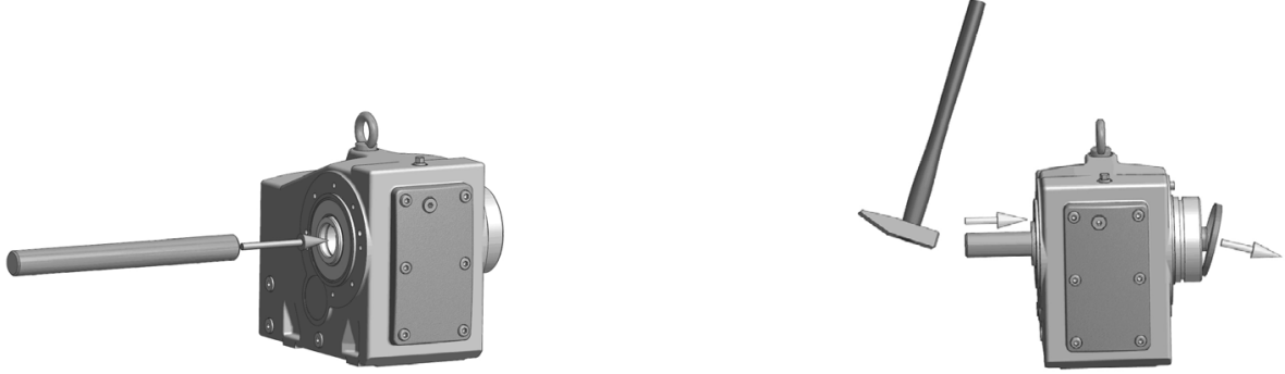
Şekil 5: Fabrikada takılan kilit başlığının sökülmesi
