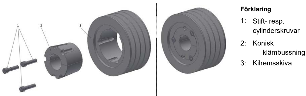
Bild 21: Kilremsskiva (demonterad/monterad)
