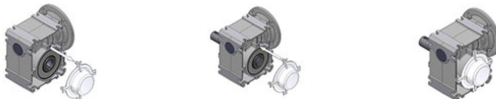
Obr. 15: Demontáž a montáž krycího víka
