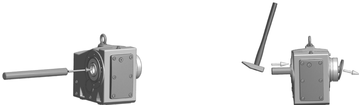
Fig. 5: Demontering av det fabrikkmonterte lokket
