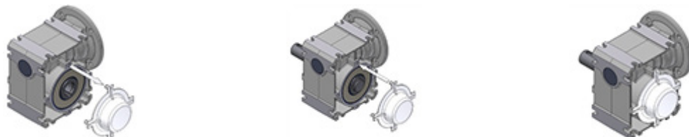
Fig. 15: Demontering og montering av dekslet
