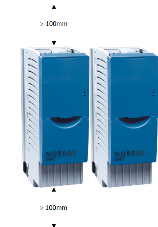
Abbildung 1: Montageabstände SK 5xxE
