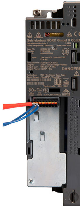
Fixieren der Anschlüsse (dritte Hand)
