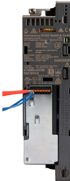
Fixation des raccords (troisième main)
