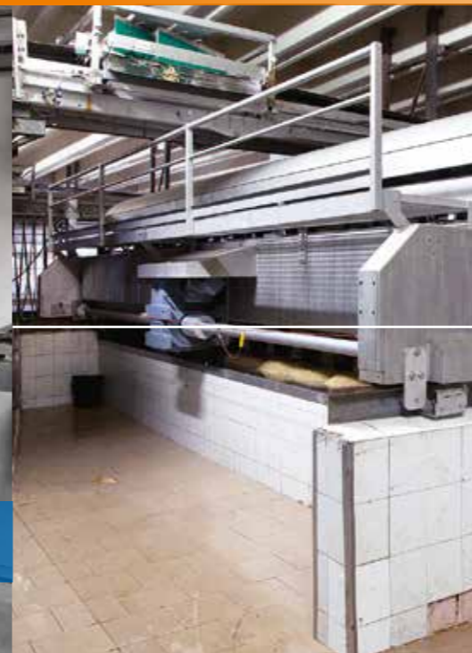
Mälzereiwender mit 14 Antrieben und Fahrtrieb
