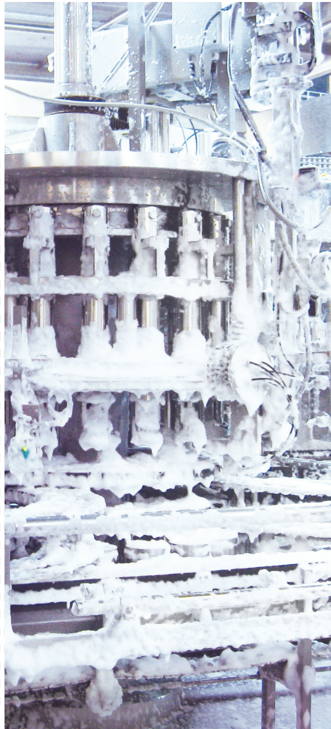
Schaumreinigung in Abfällanlagen
