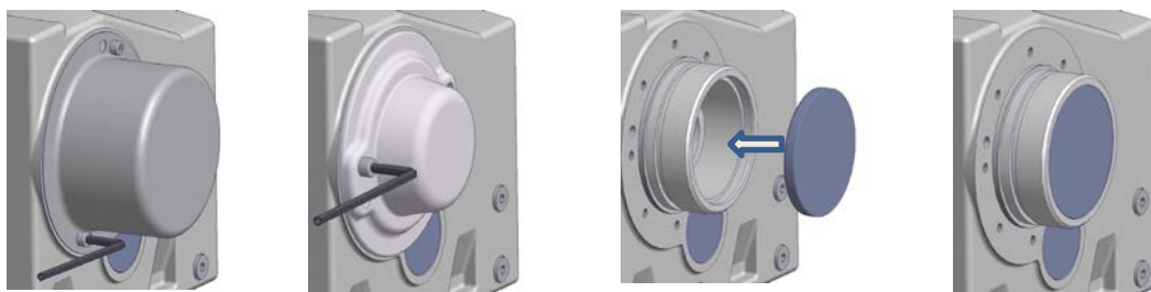
図 13: オプション SH、オプション H、オプション H66 のカバーフードの取り付け
