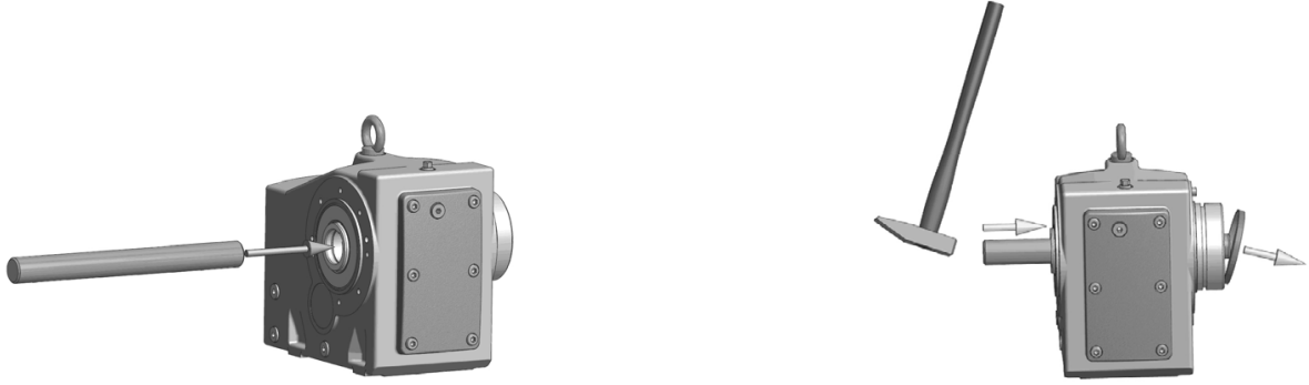
Şekil 5: Fabrikada takılan kilit başlığının sökülmesi
