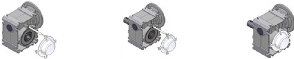
Şekil 15: Koruma başlığının sökülmesi ve takılması
