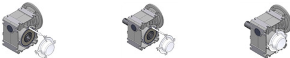
Joonis 15. Kaitsekatte eemaldamine ja paigaldamine
