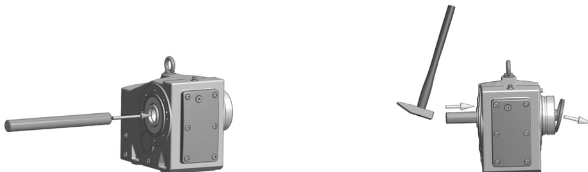
Joonis 5. Tehases paigaldatud sulgurkorgi eemaldamine
