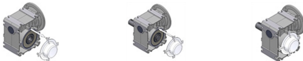
15 pav. Gaubtelio išmontavimas ir montavimas
