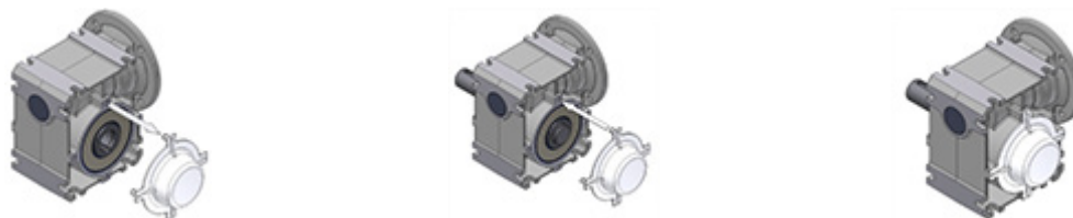
Slika 15: Demontaža in montaža zaščitne kape
