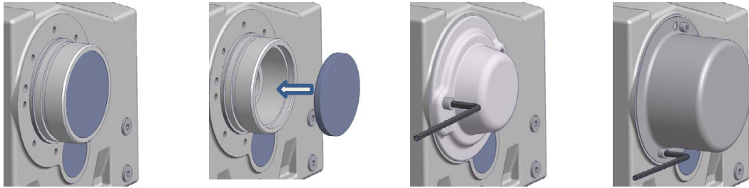
الشكل 14: تركيب الأغطية الوقائية من خيار SH وخيار H، وخيار H66
