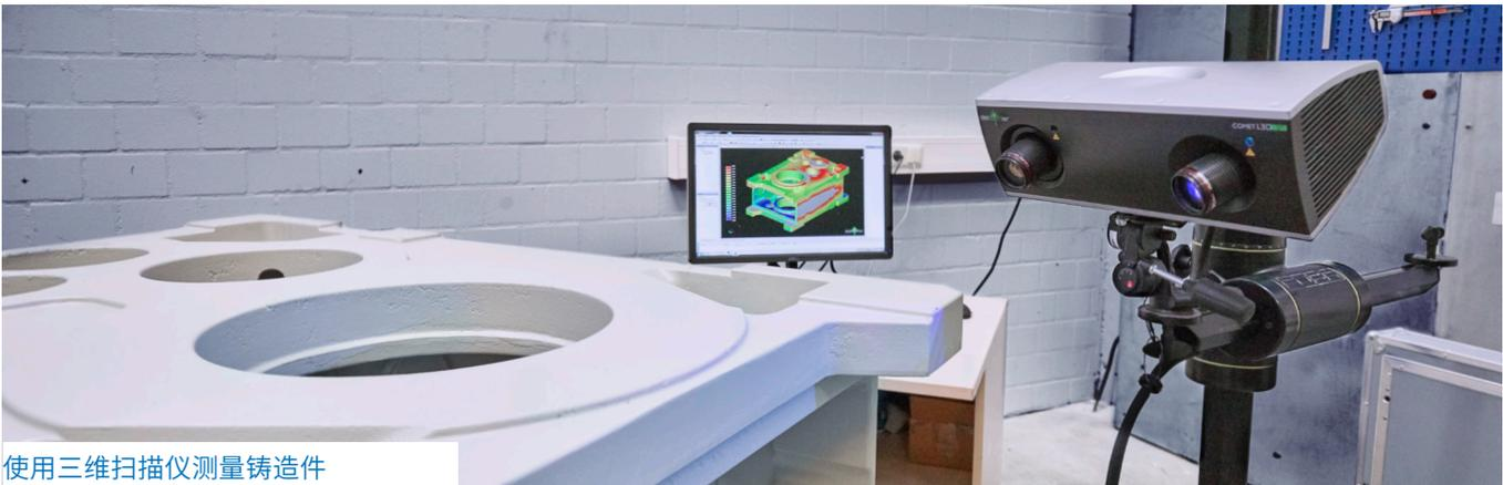
使用三维扫描仪测量铸造件
