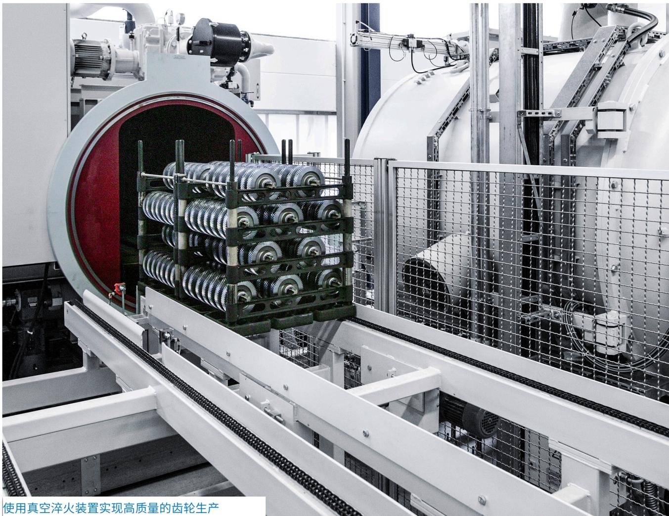
使用真空淬火装置实现高质量的齿轮生产
