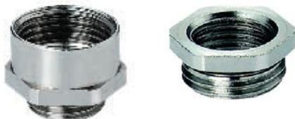
Für die Montage der M12 Anschlussenerweiterungen in eine M12 bzw. M20 Verschraubungsöffnung stehen optional leitfähige, aus Messing gefertigte, Anschlussenerweiterungen SK TIE4 M12 M16 von M12 auf M16 bzw. Anschlussreduzierungen SK TIE4 M20 M16 von M20 auf M16 zur Verfügung.
