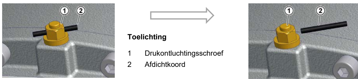
Afbeelding 21: Activeren van de drukont luchtingsschroef
