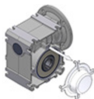
Afbeelding 14: Demontage en montage van de afdekkap
