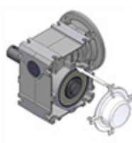
Afbeelding 14: Demontage en montage van de afdekkap
