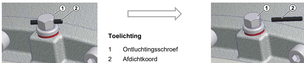
Afbeelding 20: Activeren van de ont luchtingsschroef
