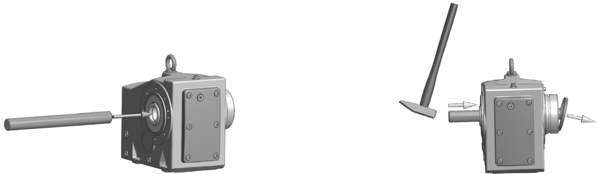
5. ábra: A gyárilag felszerelt zárófedél leszerelése
