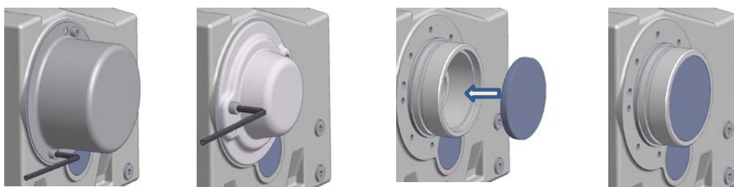
Slika 13: montaža pokrivnog poklopca opcije SH, H i H66
