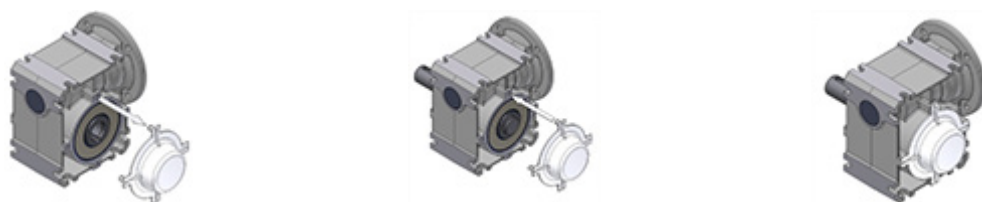
Slika 14: demontaža i montaža pokrivne kapice
