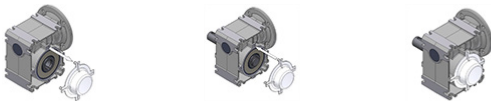
Фигура 15: Демонтаж и монтаж на предпазния капак
