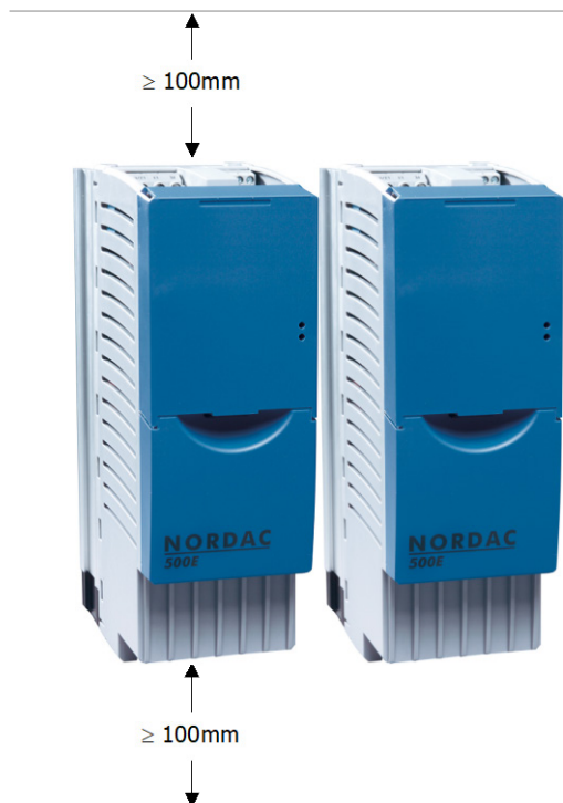
Abbildung 1: Montageabstände SK 5xxE
