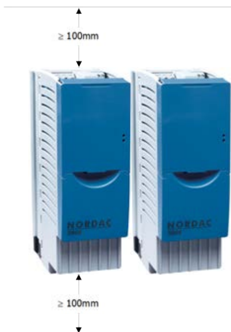
Рис. 1: Монтажные расстояния SK 5xxE
