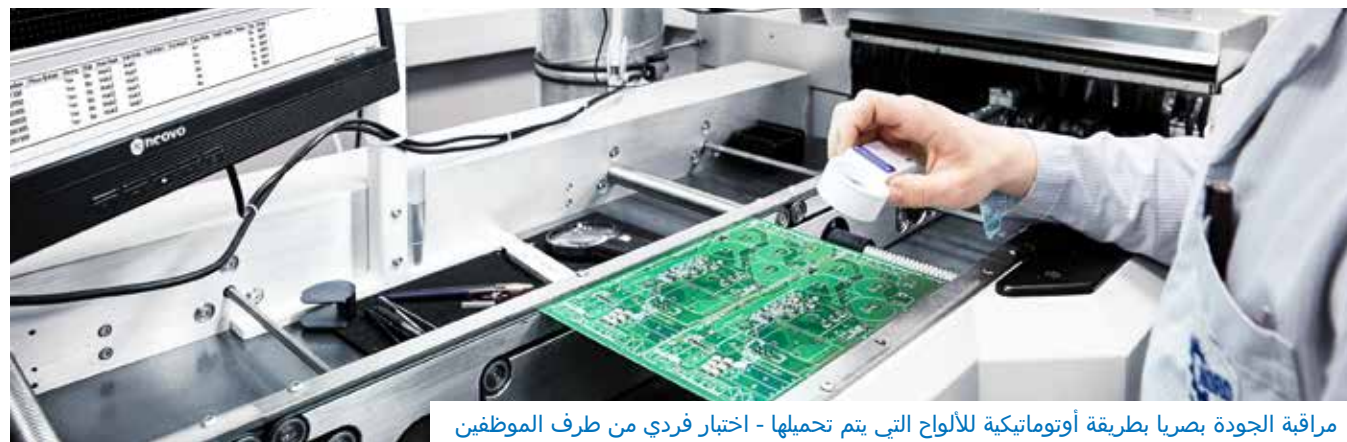
اختبار الجودة بطريقة ميكانيكية بأجهزة قياس متصلة فيما بينها
