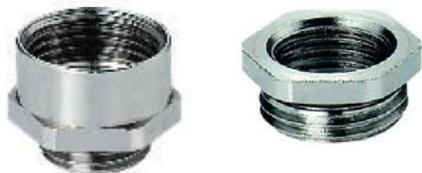
Für die Montage der M12 Anschlussweiterungen in eine M12 bzw. M20 Verschraubungsöffnung stehen optional leitfähige, aus Messing gefertigte, Anschlussweiterungen SK TIE4 M12 M16 von M12 auf M16 bzw. Anschlussreduzierungen SK TIE4 M20 M16 von M20 auf M16 zur Verfügung.
