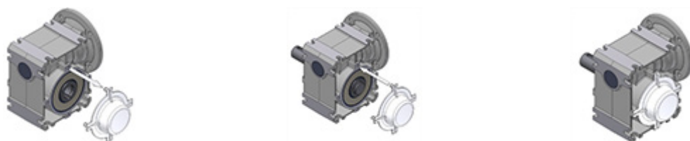
Слика 14: Демонтажа и монтажа за капакот
