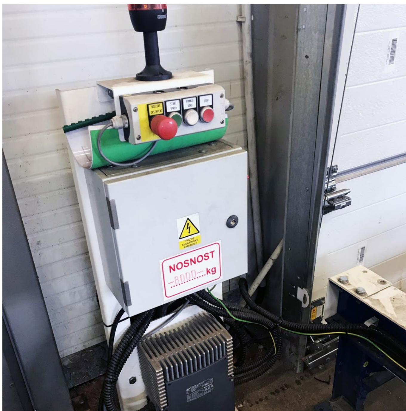
Obrázek 2 Ovládací panel k dopravníku OSTROJ RC2500 včetně decentrálního měniče frekvence NORD.
