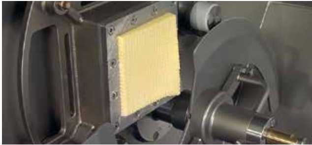
Applikationsbeispiel: Maschine zum Würfeln, Schneiden und Raspeln von Käse oder Fleisch
