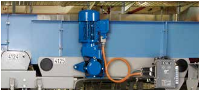
Applikationsbeispiel: Übergabeeinheit mit Bewegungssteuerung und Sensordesign-Vorverarbeitung für den Feldbusanschluss
