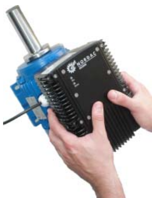
Fig.2: Démontage du SK 300E
