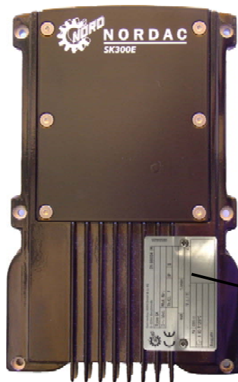
SK 300E avec plaque signalétique montée et sans LEDs
