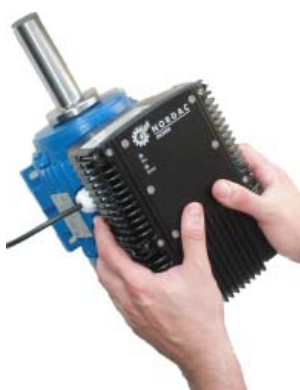
Afb. 2: Verwijderen van de SK 300E
