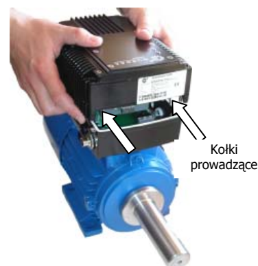
Rys. 3: Zakładanie SK 300E
