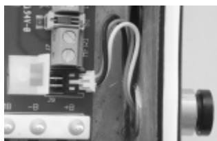
Рис.2: Подключение втулки M12
