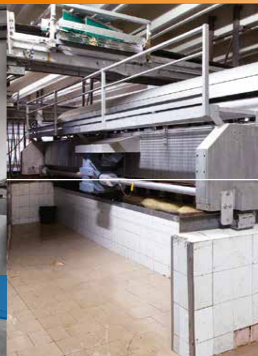
Agitateur de malterie avec 14 entraînements et système de translation
