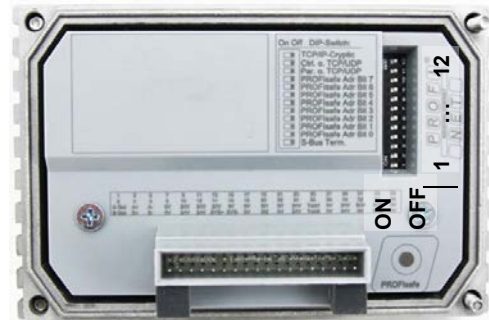
Werkseinstellung DIP-Schalter: OFF
