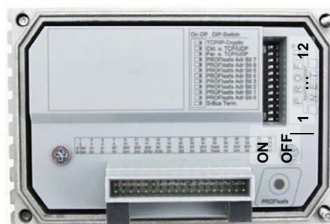
Werkseinstellung DIP-Schalter: OFF
