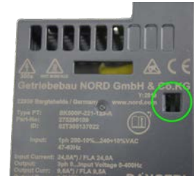
Frequenzumrichter ohne STO-Kontaktbrücke
