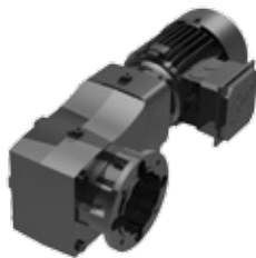
93.1 carter, bride B5, arbre creux, moteur intégré
