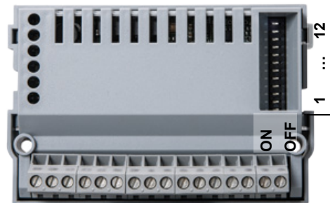
Werkseinstellung DIP-Schalter: OFF
