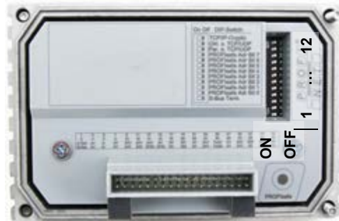
Werkseinstellung DIP-Schalter: OFF
